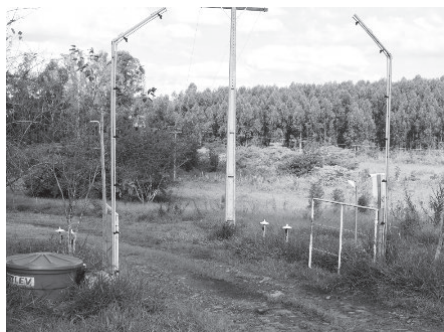
Figura 2: Ilustração de um sistema de desinfecção de veículos com sensores de passagem localizado em uma unidade de produção de frangos orgânicos.
